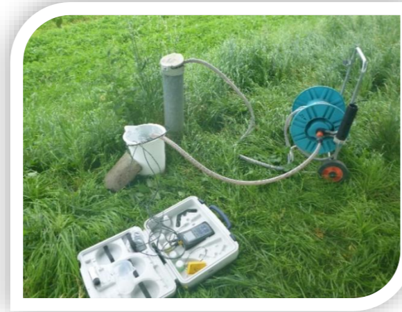
Probenahme an einer Grundwassermessstelle
